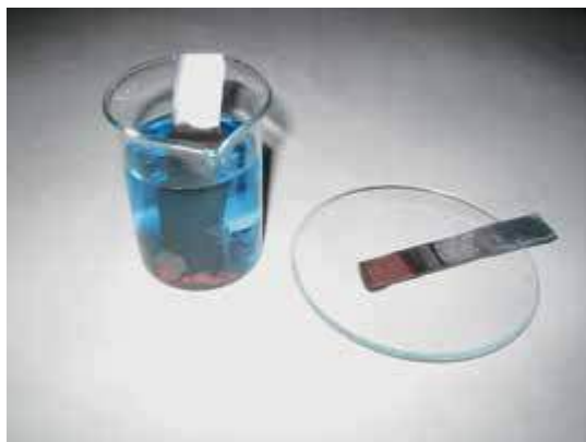
Obr. 11.1 Zinok pokrytý vrstvičkou meďi
