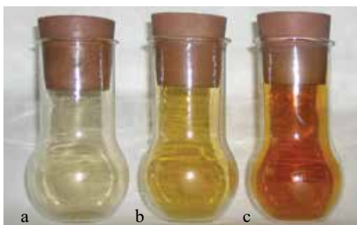
Obr. 10.3 Farba zmesi monoméru a diméru oxidu dusičitého pri rôznej teplote a) t_1 < t_2 , b) t_2 , c) t_3 > t_2
